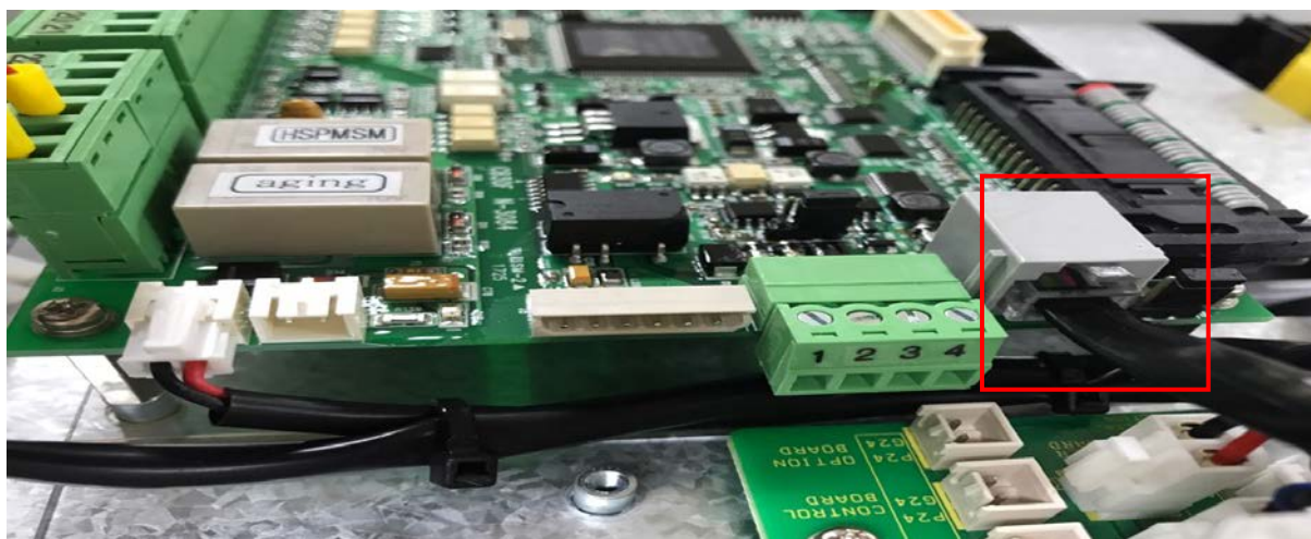
图 10.3-3 控制板的键盘连接端子
