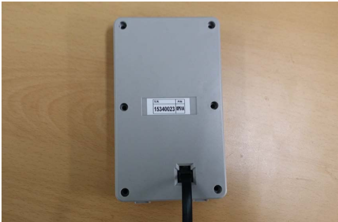
图 10.3-6 键盘(背面)连接线
