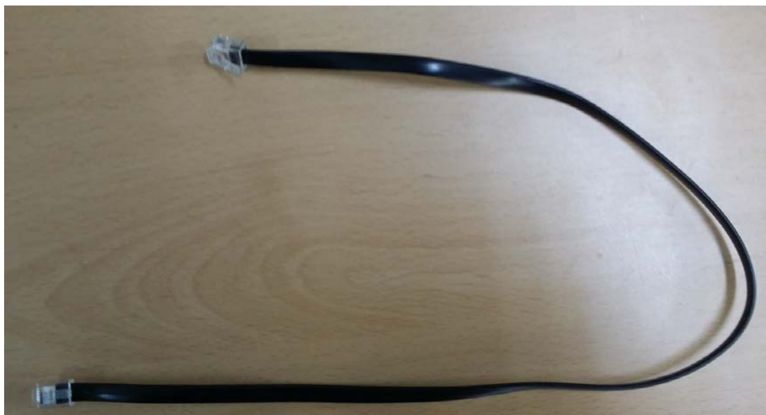
图 10.3-4 控制板和键盘的连接线
