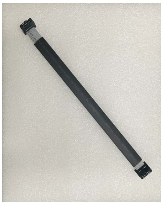
图 10.3-4 控制板和键盘的连接线
