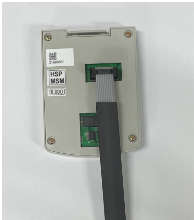
图 10.3-5 键盘(背面)连接线
